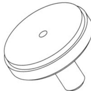
767-6720 样品针-试管底部高度调整工装
