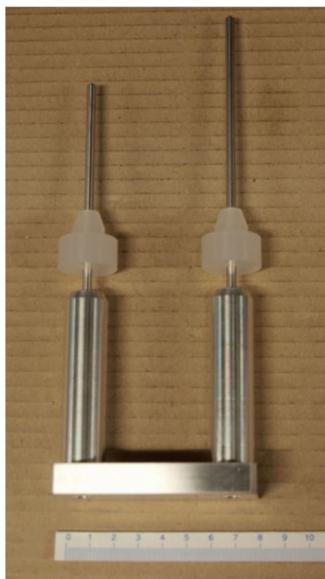
731-2961 反应槽水位检查工装
